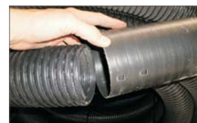
2. Enrosca ambas partes con firmeza pero sin forzarlas
